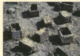
Formen zur Herstellung von Ziegeln
